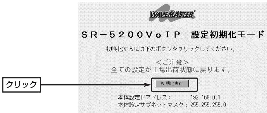
8.本製品のランプが「設定初期化」モードに移行する前の状態に戻って、「WAN側」画面を表示したら、本製品の初期化が完了です。
